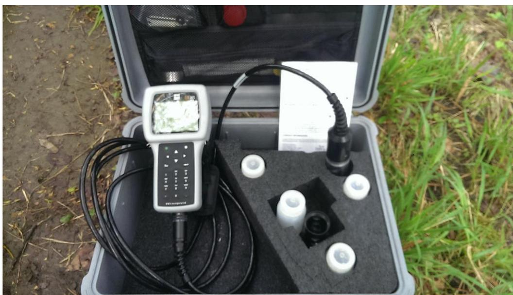
Figura 1 Sonda multiparamétrica YSI 556mp
