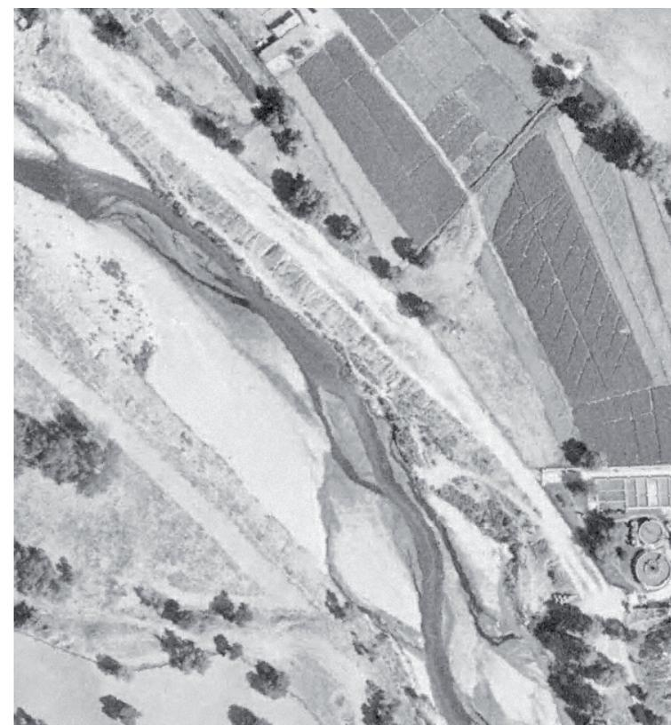
*Taludes longitudinales que rectifican el cauce, aguas abajo de El Pardo. Detalle de un fotograma del Vuelo Interministerial, septiembre de 1980*
